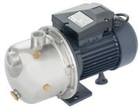
JS - однофазный одноступенчатый центробежный поверхностный насос с укороченным эжектором и корпусом из нержавеющей стали для подачи чистой холодной воды из неглубоких скважин и колодцев, открытых водоёмов, резервуаров и других источников водоснабжения.
