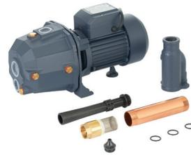
DP - однофазный центробежный одноступенчатый поверхностный насос с дополнительным внешним эжектором и корпусом из чугуна для подачи чистой холодной воды из скважин, диаметром не менее 4" (100 мм), глубоких колодцев и других источников водоснабжения. Внешний выносной эжектор увеличивает максимальную высоту всасывания до 15 метров.
