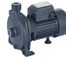
CPM - однофазный одноступенчатый центробежный консольный поверхностный насос с корпусом из чугуна для перекачивания и наполнения резервуаров. Способен перекачивать горячую жидкость температурой до 100 °С. Главной особенностью консольных насосов является высокая производительность.
