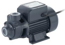
QB - однофазный одноступенчатый поверхностный насос с вихревым рабочим колесом и корпусом из чугуна для подачи чистой холодной воды из скважин, колодцев и других источников водоснабжения. Способен создавать высокий напор, имея меньший размер рабочего колеса по сравнению с центробежным насосом.
