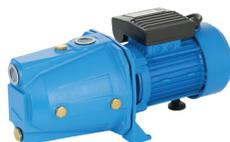
ECO JET LA - однофазный одноступенчатый центробежный поверхностный насос с удлиненным эжектором и корпусом из чугуна для подачи чистой холодной воды из неглубоких скважин и колодцев, открытых водоёмов, резервуаров и других источников водоснабжения.
