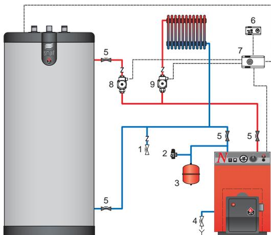
Схема с трехходовым клапаном с приводом.
