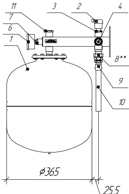
\* Для расположения предохранительного клапана справа допускается разворот консоли на 180°.
