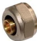
Применяется для монтажа напорных трубопроводов в системах отопления, холодного и горячего водоснабжения. Предназначен для быстрого соединения металлопластиковых труб с трубопроводной арматурой и другими элементами трубопроводов, имеющими наружную резьбу и торец под конус. Корпус фитинга выполнен из латуни, гильза из нержавеющей стали.
