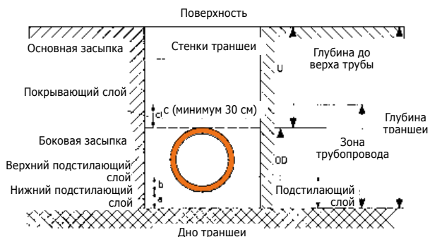
Рис. 3 Устройство траншеи
