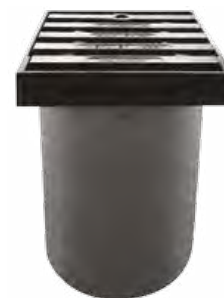
Дождеприемник TL-400 для подъемной трубы тип 425, чугунная решётка и телескопическая труба, класс нагрузки D400 - 40т / TL-400
